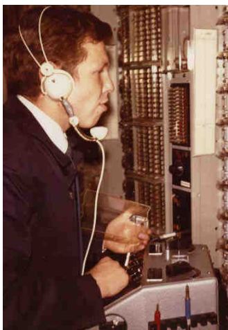
Telefon-Vermittlungsstelle Oberhausen, hinterm Hauptpostamt "damals" war noch alles "Klappertechnik", hier Klaus Gust bei der Störungsbeseitigung (ein "Kastenfeld" war für 100 Fernsprechteilnehmer nötig, welcher Platzbedarf...)
